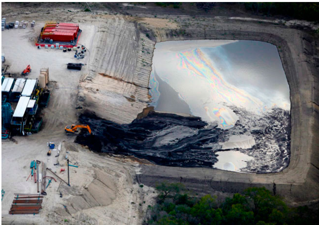
Sludge pits/ponds are used to hold exploration and production waste 泥貯めは探査と廃棄物処理に使われている
