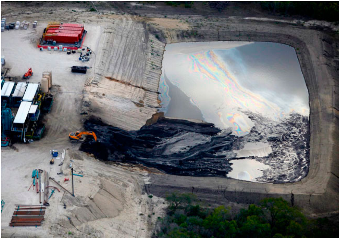
Sludge pits/ponds are used to hold exploration and production waste 泥池用來置放探勘及製造過程中產生的廢棄物
